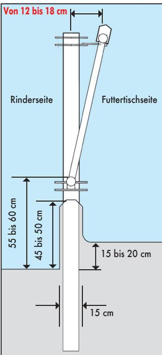
Unsere Selbstfangfressgitter sind mit Zwischenverstärkungen geliefert, 1 Verstärkung für die 3, 4 und 5 m Ausführungen und 2 Verstärkungen für die 6 m Ausführungen.
