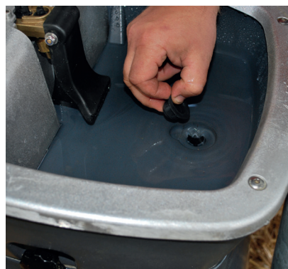
Beispiel einer Polyspring Tränke mit einer horizontalen Zunge Art-Nr. P113 07 69 (Seite 29) anstatt des Rohrventils ausgestattet.
